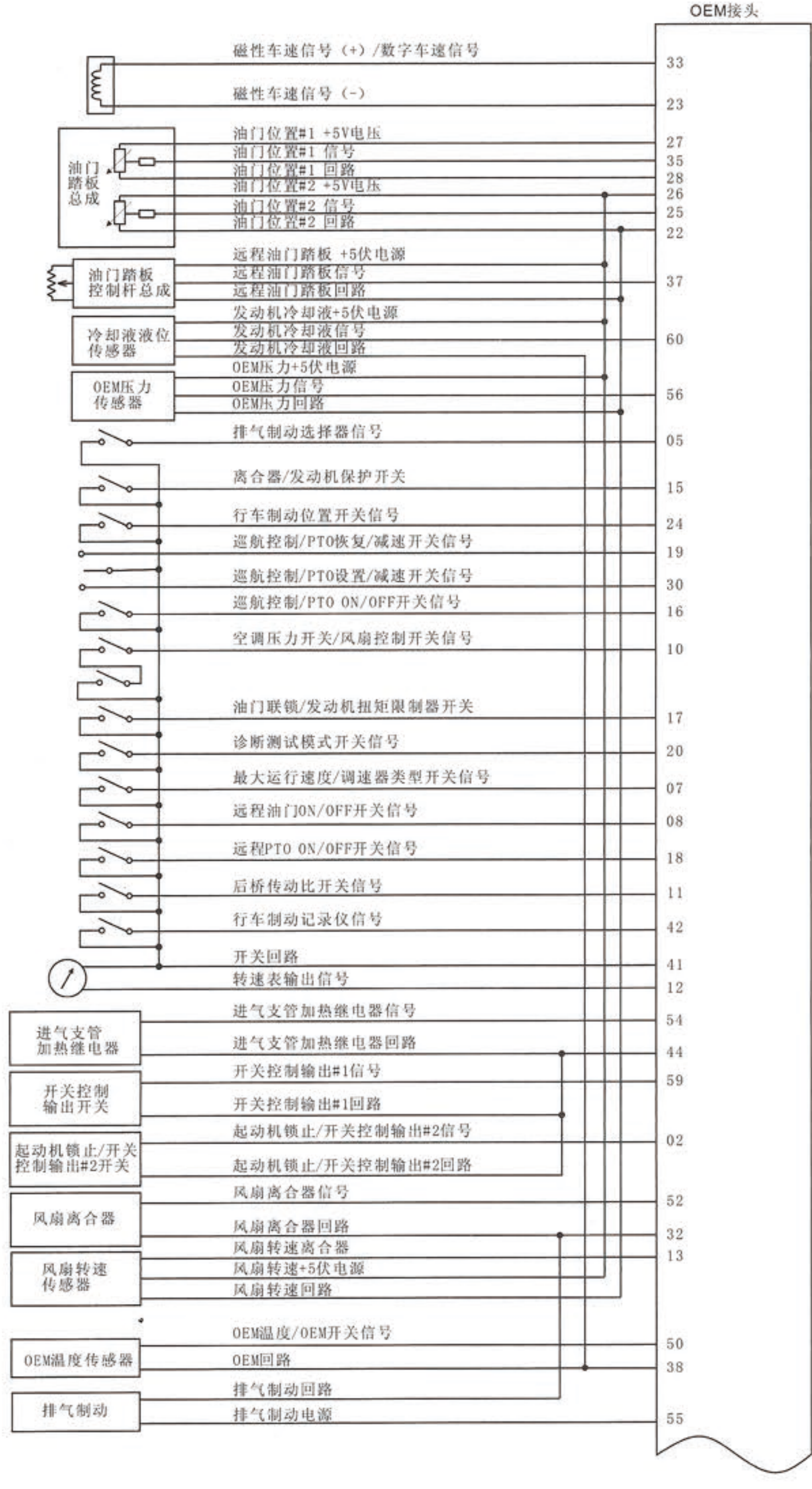
康明斯ISDE（4缸）发动机电控系统电路图
